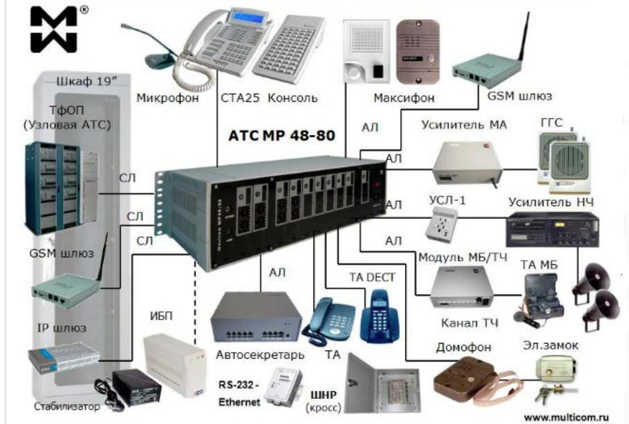
Спектр устройств, которые можно подключить к портам станции для организации гибкой и адаптивной системы связи, очень широк.
