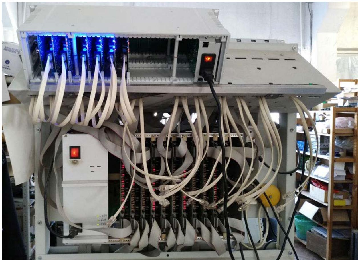
На фотографии - МАКСИКОМ MP48 в конкретной конфигурации проходит очередной этап проверки. На снимке видно, что не все свободные слоты базового блока заполнены платами расширения.
