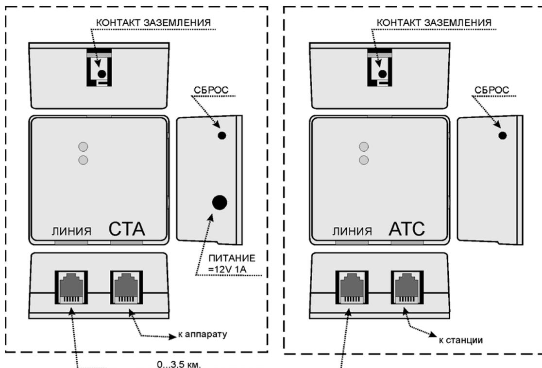
Изделие предназначено для увеличения длины линии связи между АТС и системным аппаратом Максиком СТА20/25/30. Максимальная длина линии связи от АТС до установленного СТА по кабелю категории 5Е составляет не менее 3000 метров.
